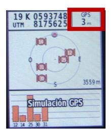
**COLUMNA 7.- NÚMERO DE PUNTO**: en esta parte del formulario deberá anotar el número correlativo, marcado en el GPS para diferenciar un dato de otro y que se encuentra en la parte superior izquierda de la pantalla.
