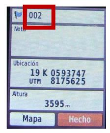
**COLUMNA 8.- ALTURA:** Se debe registrar el dato de altura que marca el equipo en la parte inferior media de la pantalla.
